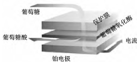
图2 植入式微型酶电极葡萄糖传感器工作原理示意
